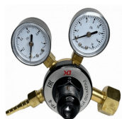
Регулятор углекислотный УР-6-5, давление до 0,6МПа, пропускная способность 6 м 3 /ч, корпус латунь
