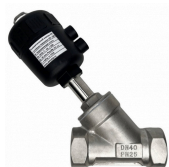
Клапан пневматический НЗ прямого действия с угловым поршнем JZF-16P, Ду 40мм, G1 1/2, NBR, Т: -10...+180С
