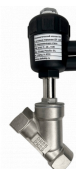
Клапан пневматический НЗ прямого действия с угловым поршнем JZF-16P, Ду 25мм, G1, NBR, Т: -10...+180С
