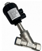
Клапан пневматический НЗ прямого действия с угловым поршнем JZF-16P, Ду 20мм, G3/4, NBR, Т: -10...+180С
